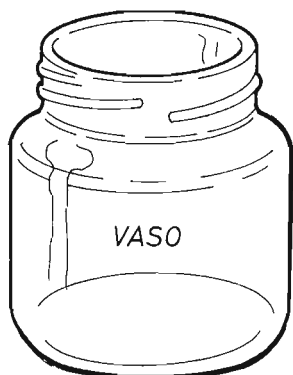
Fig. 6 - Schema di composizione del vaso contenitore di soluzioni acide. Le quote, qui riportate, sono tutte espresse in millimetri. Il coperchio del vaso è di latta e l'elettrodo positivo di rame rimane elettricamente isolato da questo tramite un dado passante.
