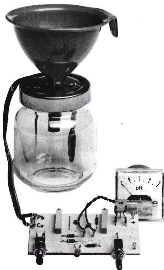
Fig. 7 - Per meglio illustrare la composizione del vaso contenitore, il coperchio di questo, nel nostro prototipo, è rimasto allo stato naturale. Ma, a realizzazione avvenuta, il coperchio di latta deve essere integralmente coperto con stucco al silicone per impieghi idraulici e protettivi contro infiltrazioni e perdite d'acqua.
